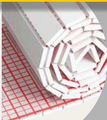
Маты ТИЛИТ ТП состоят из плотного пенополистирола, алюминиевой фольги и защитной полимерной пленки со специальной разметкой. Высокопрочный пенополистирол, являясь эффективным теплоизолирующим материалом, не допускает образования трещин в стяжке при нагрузке и надежно удерживает гарпунные скобы, фиксирующие нагревательные элементы. Алюминиевая фольга обеспечивает однородность нагрева по всей площади пола. Благодаря химически стойкому полимерному покрытию алюминиевая фольга не подвержена коррозии.
