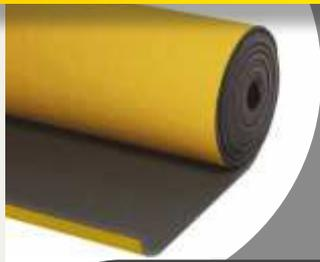
ТИЛИТ Блэк Стар Дакт - это самоклеящийся материал для тепло-звукоизоляции воздуховодов систем вентиляции и кондиционирования. Изготавливается из вспененного полиэтилена, имеет закрытую ячеистую структуру. Надежно защищает от конденсата и тепловых потерь, является эффективным шумопоглощающим и вибродемпфирующим материалом. Прост в установке, безвреден для здоровья и окружающей среды.
