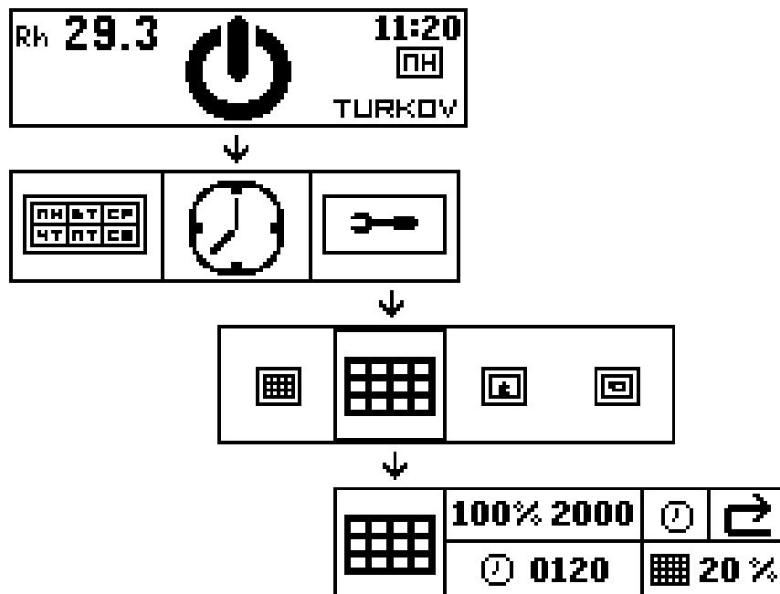
**100% 2000** «Установка» времени отработки фильтра.
