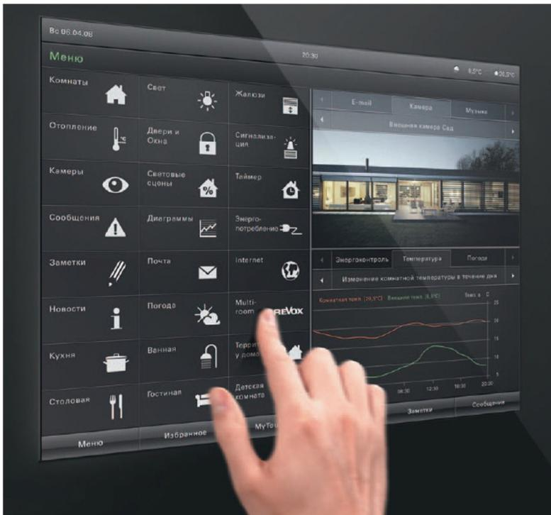
«Умный дом» подключается к пульту управления через порт RS485, по протоколу ModBus. Распространенность протокола позволяет интегрировать оборудование в любую систему умного дома.
