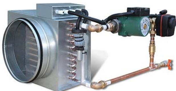
Все установки с водяными нагревателями оборудуются качественным медно-алюминиевым теплообменником, медным смесительным узлом с паяными соединениями и необходимым комплектом датчиков.
